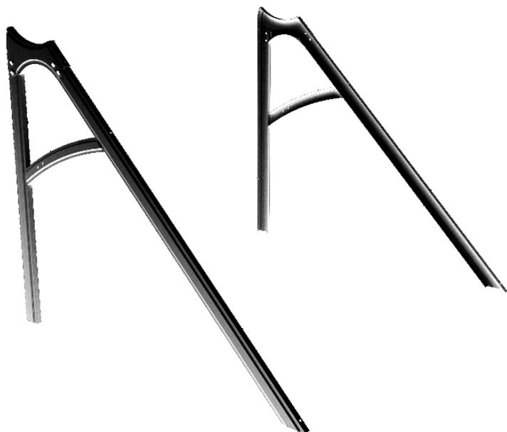
Complete el armado de la estructura colocando los tirantes traseros en forma cruzada, el tirante frontal y los tirantes cortos como se observa en la figura.
